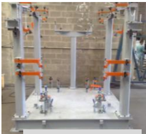
Сварка рамы прихваточным швом
